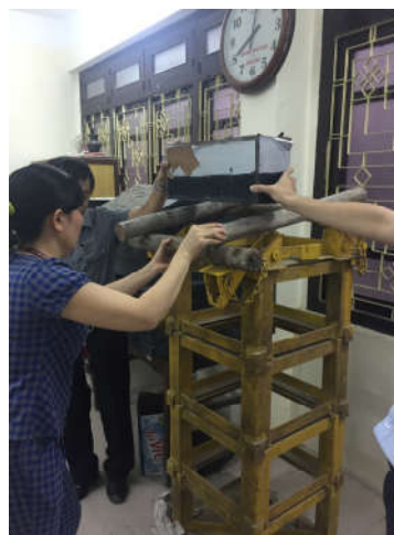
Hình 1.6. Tháo các thanh gỗ chèn trên nóc vì chống
