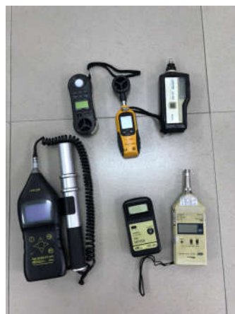
Các thiết bị đo bụi, tốc độ gió, nhiệt độ trong mỏ hầm lò
