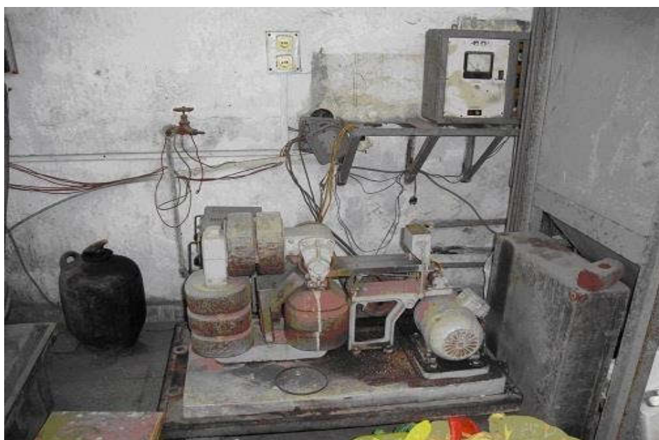
Hình 7: máy tuyền từ khô thí nghiệm
